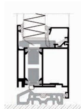
ECO-Konstruktion mit 106 mm hohem Fußpunkt, mit umlaufenden Flügel (nicht einstellbar)
