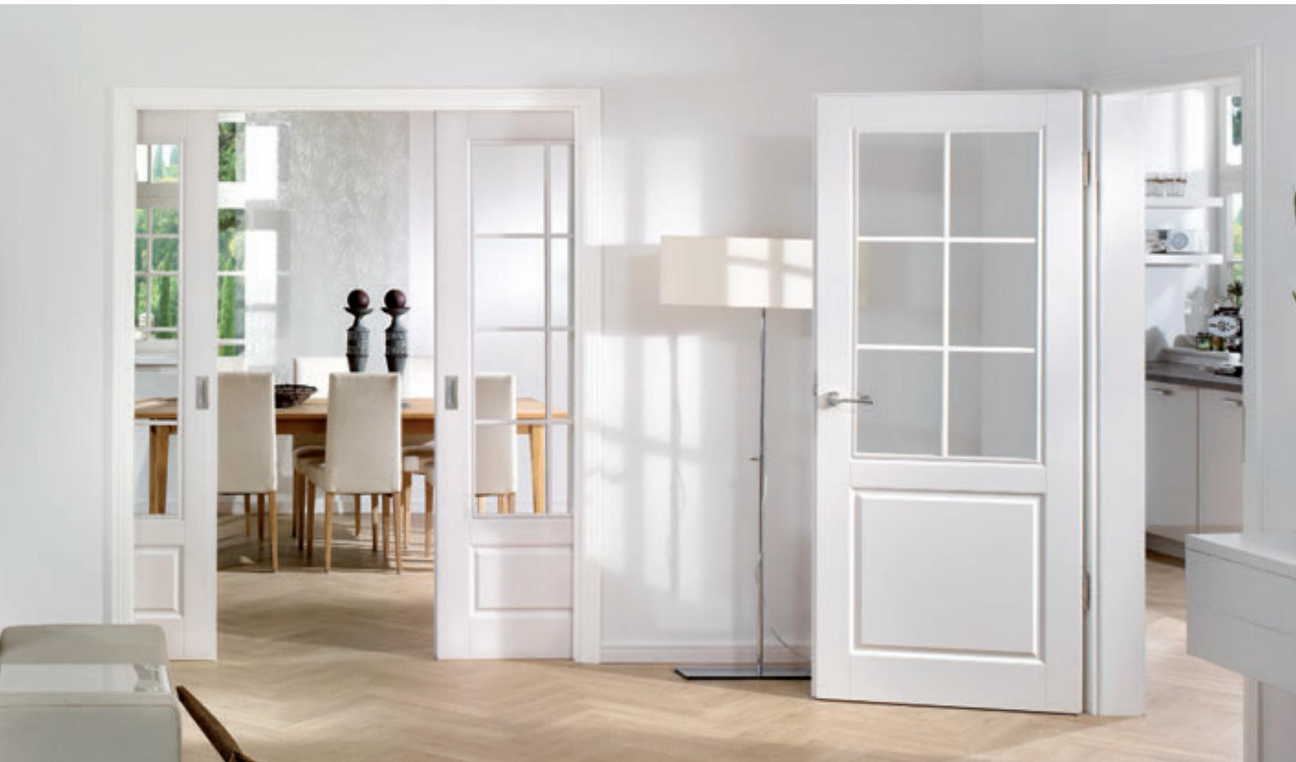
Modell Park Lane | Typ 2220, Schiebetür in Wand, Lichtausschnitt mit Sprossenrahmen, Klarglas RAL 9010 | Zarge eckig, 2 Rillen, 70 mm | HGM Fußleiste mit einer Rille
