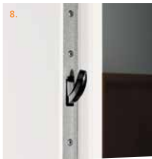
Mehrfachsicherheitsschloss mit Schwenkriegel (nur für Einbruchhemmung RC3 in Verbindung mit Doppelfalz) Als Standard wird geliefert: Mehrfachverriegelung mit Rundbolzen
